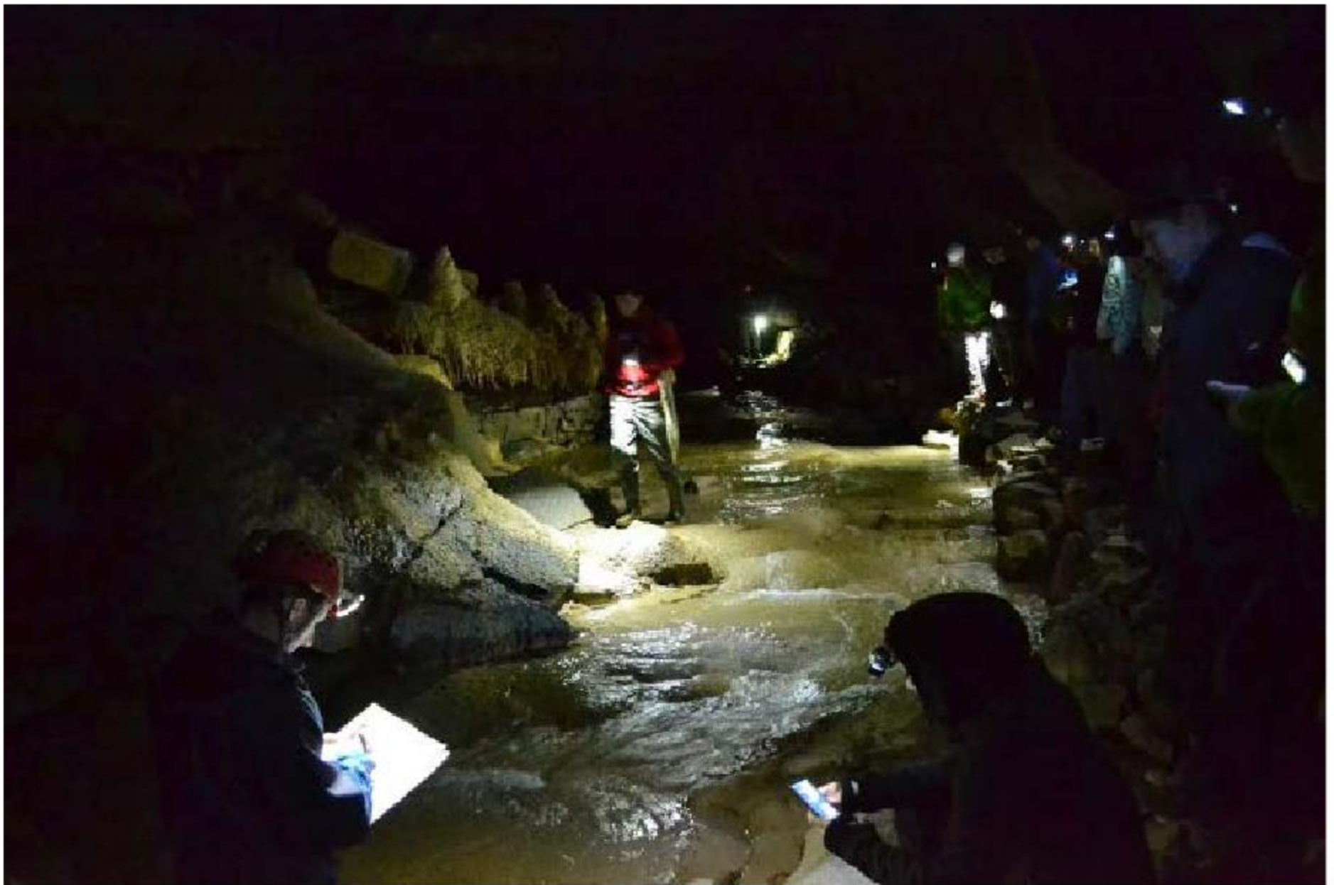
Slika 2: Merjenje pretoka z metodo prevodnosti v Križni jami (foto: Alenka Jelen).
